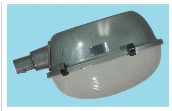
**Construção:** corpo refletor estampado em chapa de alumínio de alta pureza e anodizado brilhante; suporte com encaixe liso para tubo com Ø 25,4 m/m e; para a versão (PP) fechos e anel de segurança em aço inox; hermeticamente fechado através de junta de vedação; soquete cônico em porcelana com rosca E-27 ou E-40; fiação em cabo flexível de 1,5 m/m<sup>2</sup>.
