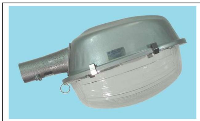
**Construção:** Corpo refletor e aro em chapa de alumínio estampado e anodizado brilhante; Refrator em (PP) fixado ao corpo através de fechos de pressão e anel de segurança em aço inox; hermeticamente fechado com junta de vedação; suporte em liga de alumínio fundido, pintado em esmalte sintético na cor cinza martelado, com encaixe para tubo de 48,30 ou 60,30 m/m de diâmetro externo; soquete cônico em porcelana vitrificada com rosca E-40; fiação em cabo flexível de 1,5 m/m<sup>2</sup>.
